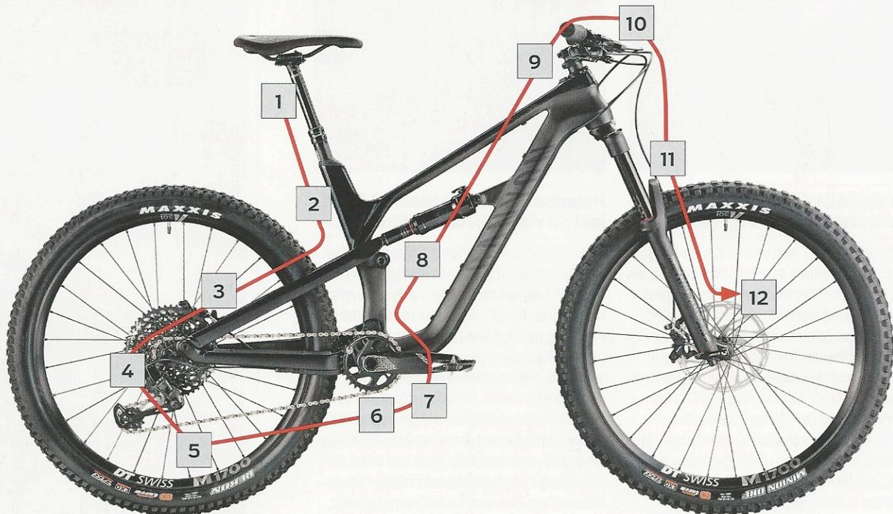
**1 Vario-Stütze** Überprüfe, ob die Vario-Stütze leichtgängig und vollständig ausfährt. Falls nicht, den Seilzug tauschen oder die Leitung entlüften. Alle weiteren Wartungsoptionen sind sehr eingeschränkt. Gibt die Stütze bei Belastung deutlich nach oder hat starkes, seitliches Spiel, muss sie zur Hersteller-Service. Sattelklemmung auf festen Sitz prüfen.
